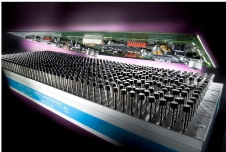
**Die Belastung auf ein Bauteil durch ein Stift beträgt bei 10kg Rakeldruck auf eine Doppelleuropa Leiterplatte nur 32,4 Gramm je Stift! Ein Keramik Bauteil darf maximal eine Belastung von 200 Gramm ausgesetzt sein.
