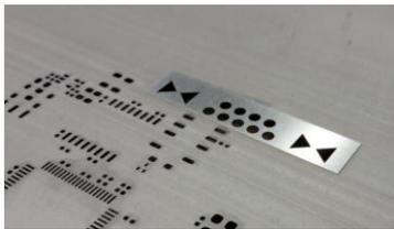
Bspw. eine Steckerleiste oder Leistungsbauteil und ein metrisches Bauteil der Größe 0201.
